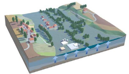
Inondation par remontée de nappe
